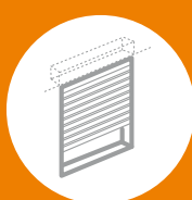
Geïntegreerd rolluik in de spouwmuur
